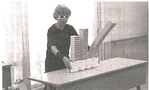
スポンジのビルによる揺れ方の実験
